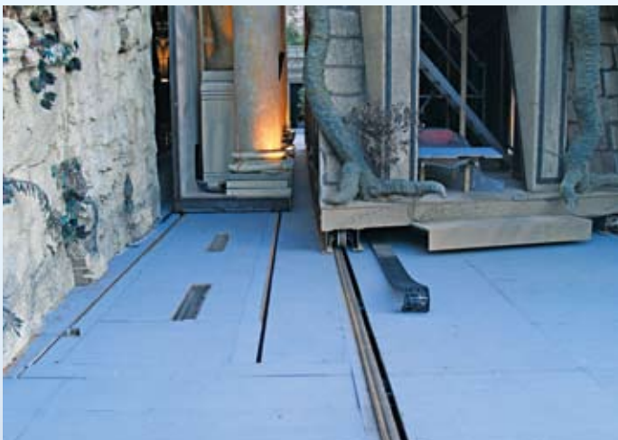
Die auf Schienen laufenden Dekorationsteile: Rechts die Löwenkopfhälfte und links dahinter die ebenfalls sich bewegende Tempelfront mit den Säulen
