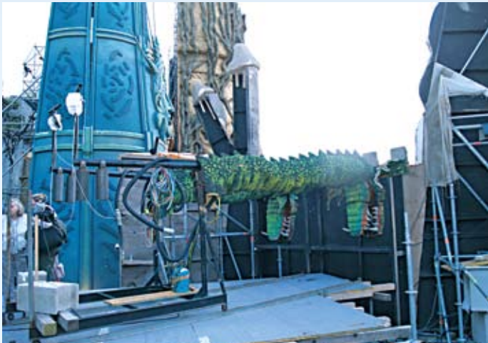
Die Drachenköpfe werden händisch geschoben und geschwenkt. In ihrem Maul sind Gasbrenner montiert
