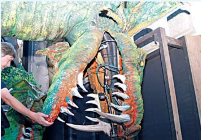
Die Drachenköpfe werden händisch geschoben und geschwenkt. In ihrem Maul sind Gasbrenner montiert
